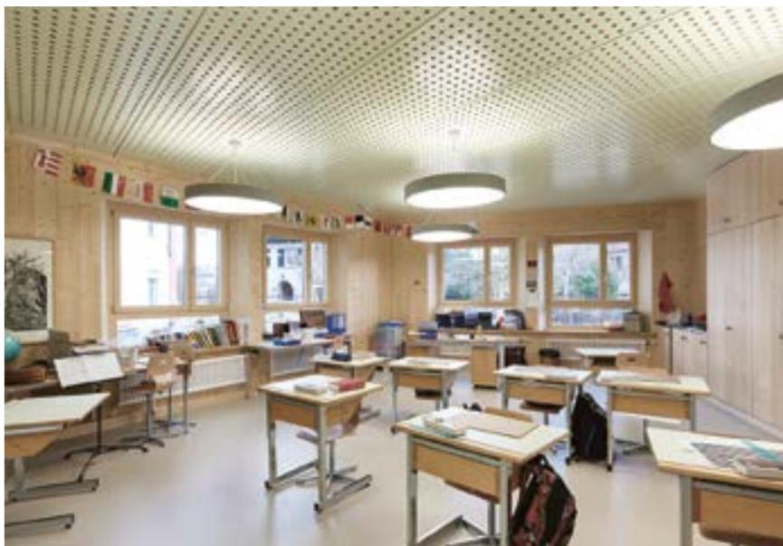
Geschossdecken und Dach aus Lignaturelementen mit perforierter Deckenuntersicht
